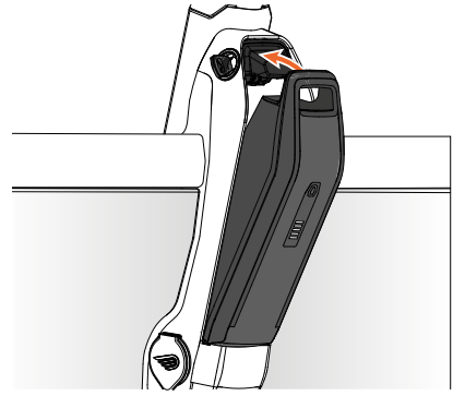
Abbildung 13 - Lassen Sie den Akku im oberen Akkuhalter einrasten..
