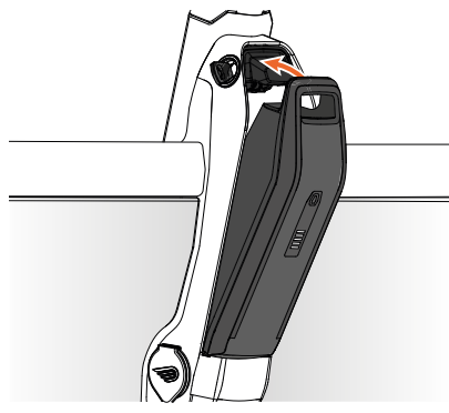
Figure 13 - Engagez la batterie dans le support supérieur.
