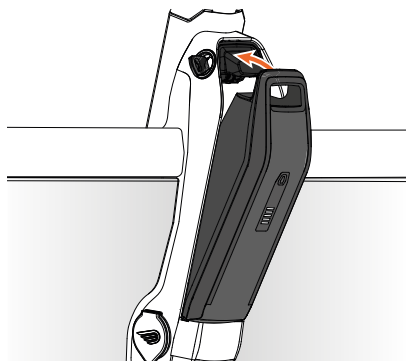
Figuur 13 - Klik de accu in de bovenste accuhouder.
