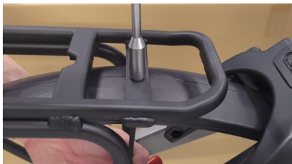
Abbildung 9 - Befestigung des Gepäckträgers am Kotflügel.
