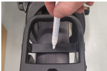
Abbildung 7 - Markierung des Bohrlochs auf dem Radspritzschutz.
