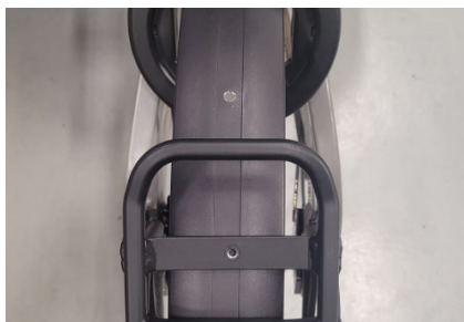
Abbildung 8 - Bohren eines Lochs in den Radspritzschutz.
