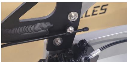
Figure 10 - Serrez les boulons du porte-bagages et de la barre de garde-boue.
