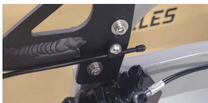
Afbeelding 10 - Vastzetten bouten bagagedrager en spatbordstangen.
