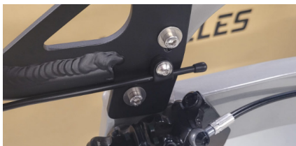
Abbildung 10 - Ziehen Sie die Schrauben des Gepäckträgers und der Kotflügelstange fest.
