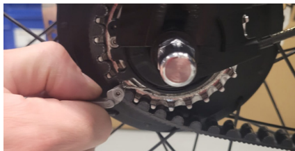
Abbildung 4 - Abnehmen der Schaltzüge.
