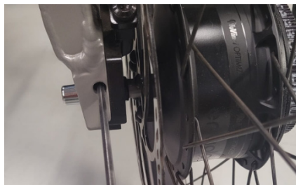
Figure 3 - Retirez la tension de la courroie.
