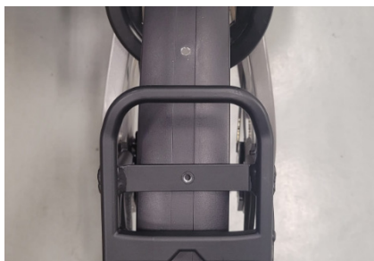
Figure 8 - Perçage d'un trou dans le garde-boue.
