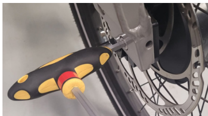
Abbildung 13 - Sicherung der Ausfallenden.
