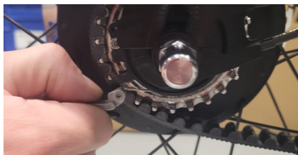
Figure 4 - Retrait des câbles de l'engrenage.
