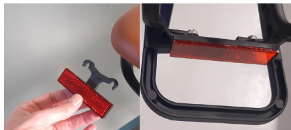
Abbildung 1 - Montage des Reflektors am Gepäckträger.
