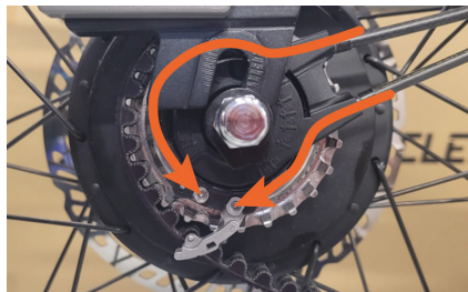
Figure 11 - Remplacez les câbles de changement de vitesse.
