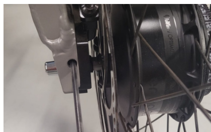
Abbildung 3 - Entfernen Sie die Spannung des Riemens.
