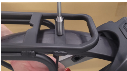
Figure 9 - Fixation du porte-bagages au garde-boue.
