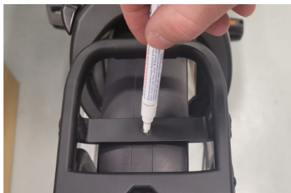
Figure 7 - Marquage du trou de forage sur le garde-boue.
