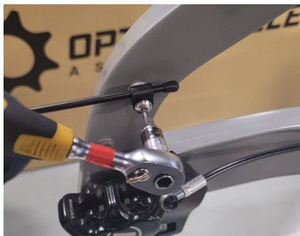
Abbildung 5 - Abnehmen der Kotflügelstangen.
