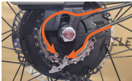
Abbildung 11 - Schaltzüge wieder platzieren.
