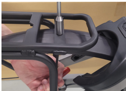
Afbeelding 9 - Vastzetten bagagedrager op spatbord.
