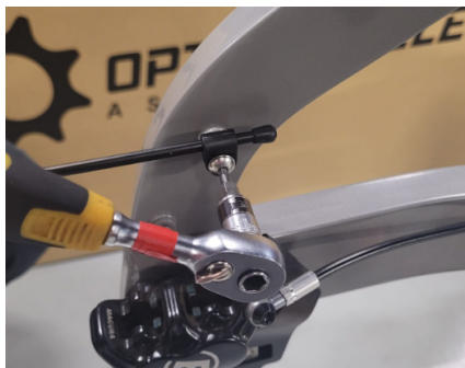
Figure 5 - Retrait des tiges du garde-boue.
