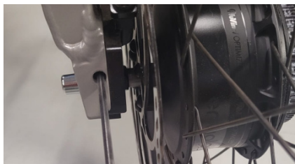
Abbildung 12 - Spannen des Riemens.
