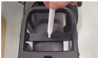
Afbeelding 7 - Aftekenen boorgat op spatbord.
