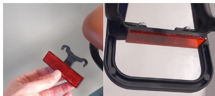
Figure 1 - Montage du réflecteur sur le porte-bagages.
