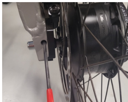
Afbeelding 3 - Verwijderen spanning op belt.
