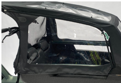
Figuur 12 - Deuren plaatsen.
