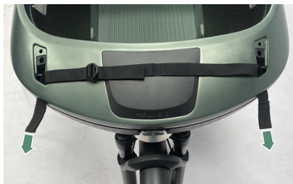
Figure 7 - Pose de la bande de montage.
