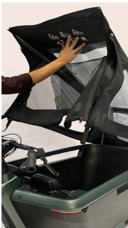
Figure 23 - Ouverture de la protection de pluie.
