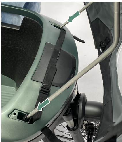
Figure 8 - Installation des piquets de tente.
