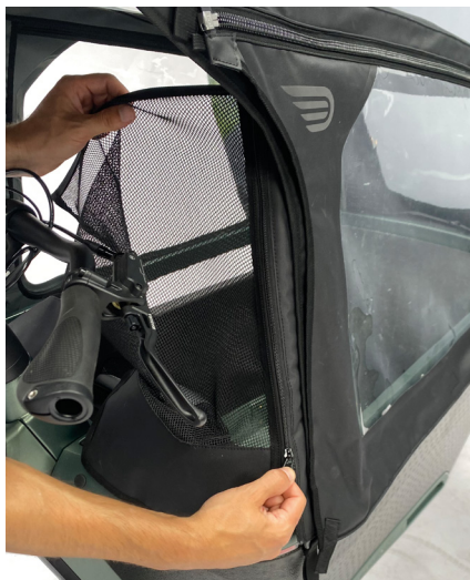
Figure 13 - Installation du filet arrière.
