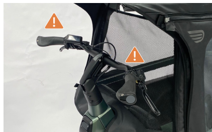
Figure 14 - Vérifiez le réglage des leviers de frein en combinaison avec la protection de pluie.
