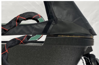
Figuur 19 - Slot plaatsen
