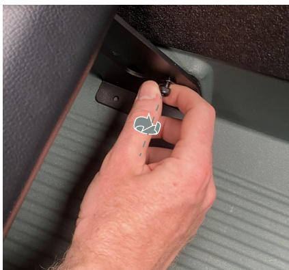
Abbildung 7 – Schrauben handfest anziehen.
