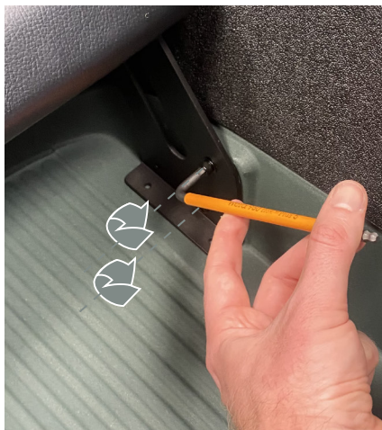
Figure 9 - Serrage des boulons.
