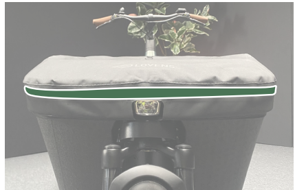
Figuur 3 - Led strip box cover uitlijnen
