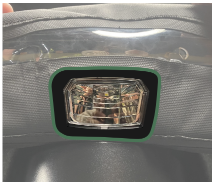
Figure 4 - Alignement du feu avant avec le trou
