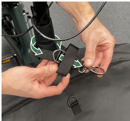
Abbildung 6 – Boxabdeckungs-Einstellband um das Lenkrohr schlingen
