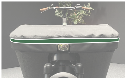
Figure 3 - Alignement du cache du boîtier de la bande LED
