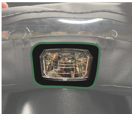
Abbildung 4 – Aussparung an der Frontleuchte ausrichten
