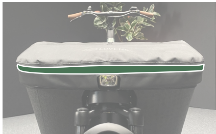
Abbildung 3 – Transparenten Teil des Covers über die LED-Leiste ziehen
