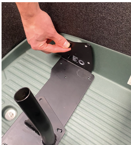
Figuur 5 - Bouten altijd recht indraaien met de hand.
