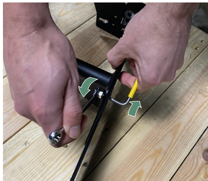
Figuur 4 - Voorlicht uitlijnen met gat
