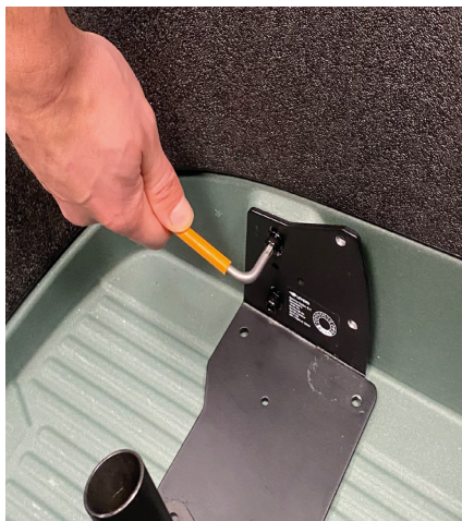
Figuur 7 - Bouten altijd recht indraaien met de hand.
