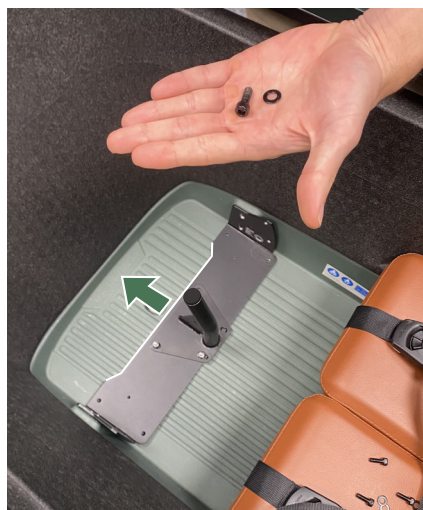
Figure 5 - Mise en place de l'adaptateur pour siège enfant dans le bac.
