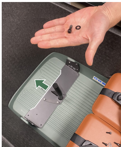
Figuur 5 - Fietsstoel adapter in bak plaatsen.
