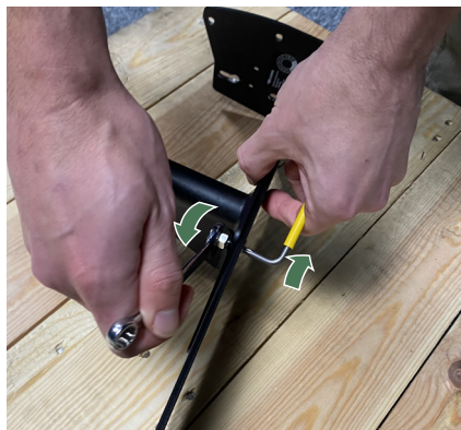
Abbildung 4 – Adapter und Grundplatte befestigen.
