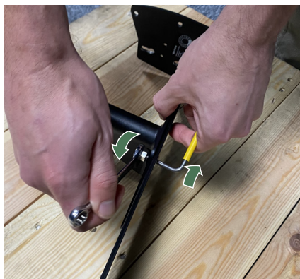
Figure 4 – Fixation de l'adaptateur et de la plaque de base.
