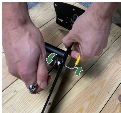
Figuur 4 - Adapter en basisplaat vastzetten.
