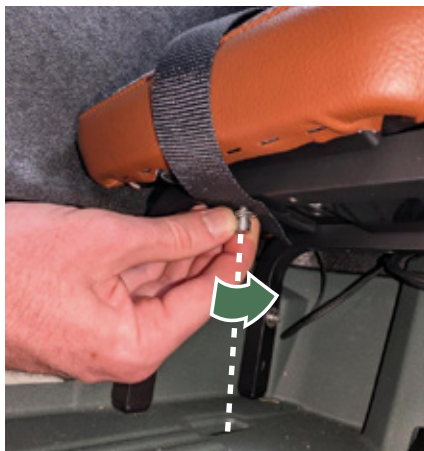
Figure 13 - Fixation de la partie inférieure de la courroie.
