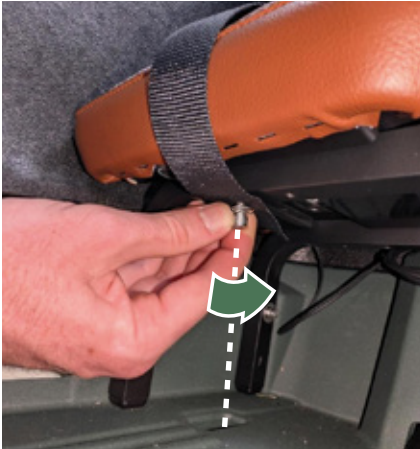
Abbildung 13 – Befestigung des unteren Gurtteils.
