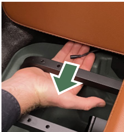
Figure 5 - Débrancher le câble.
