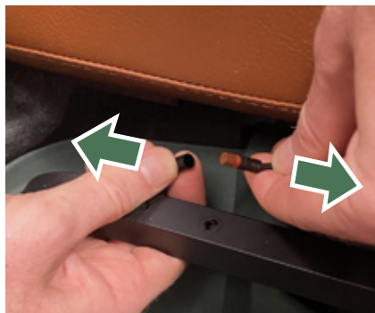
Figuur 6 - Beschermkap kabel verwijderen.
