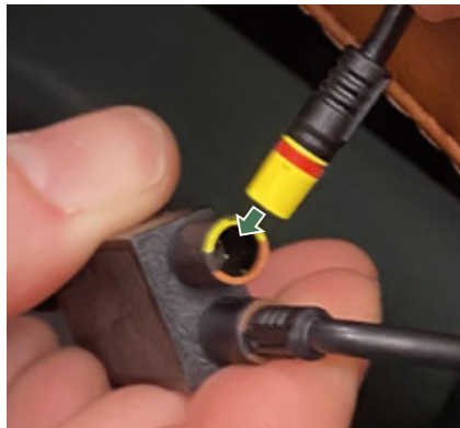
Abbildung 8 – Gelbes Kabel anschließen.
