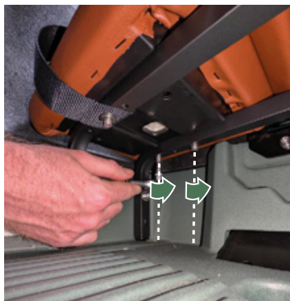
Figuur 15 - Achterzijde van het zitje vastmaken.
