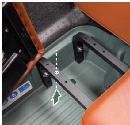
Figure 14 - Trou de fixation à l'avant.
