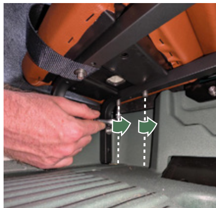
Figure 15 - Fixation de l'arrière du siège.
