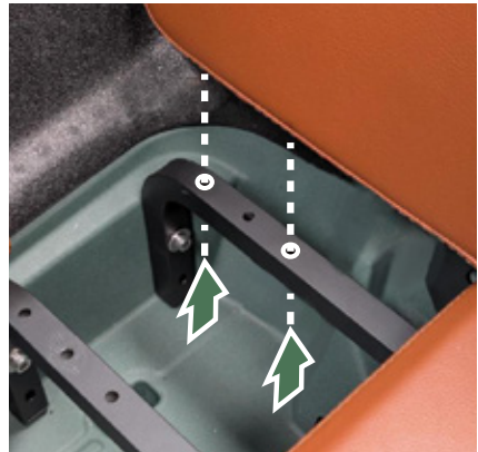
Abbildung 16 – Befestigungslöcher an der Rückseite.
