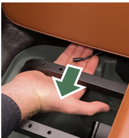
Figuur 5 - Kabel losmaken.
