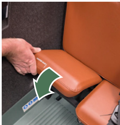
Abbildung 12 – Sitz auf den Sitzrahmen setzen.
