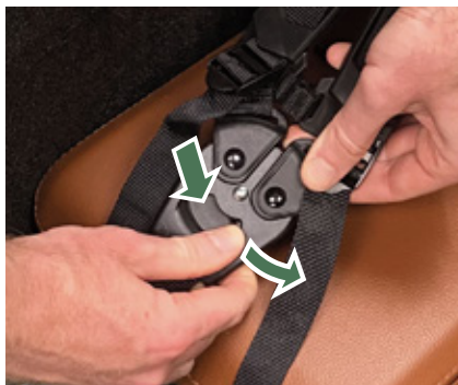
Abbildung 17 – Öffnen der Schnalle.
