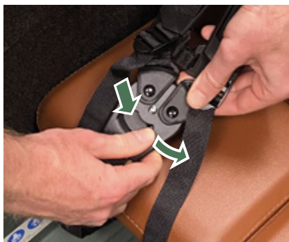
Figure 12 - Ouverture de la ceinture.
