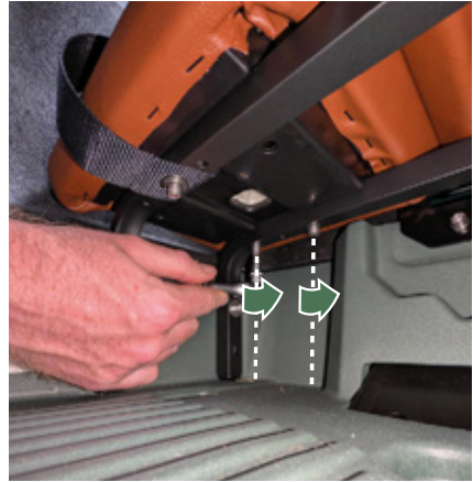
Abbildung 15 – Rückseite der Zitheizung befestigen.
