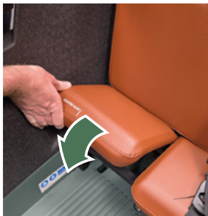
Figure 12 - Mise en place de l'assise sur le cadre du banc.
