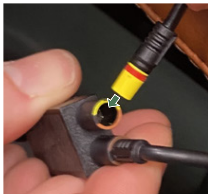
Figure 8 - Raccordement du câble jaune.
