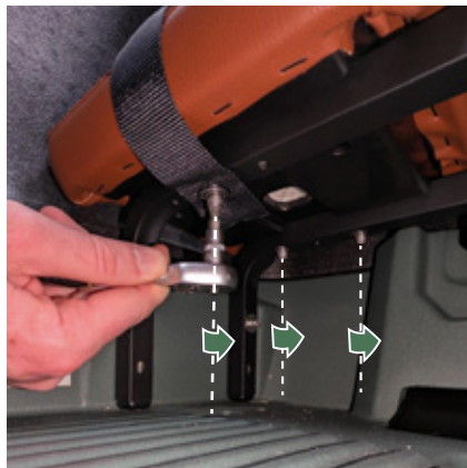
Figuur 2 - Zitvlak losschroeven.
