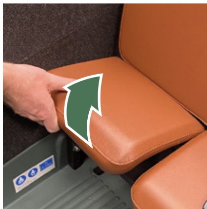
Figuur 3 - Zitvlak verwijderen.
