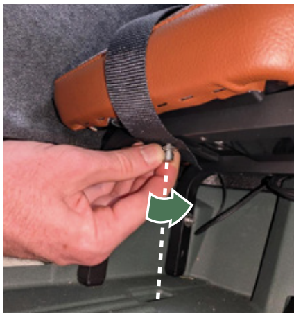
Figuur 13 - Onderste riemdeel bevestigen.
