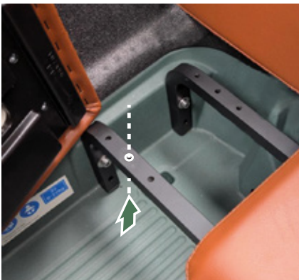
Abbildung 14 – Befestigungsloch an der Vorderseite.
