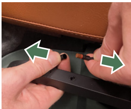
Figure 6 - Retirer le capot de protection du câble.
