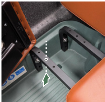
Figuur 14 - Bevestigingsgat voorkant.
