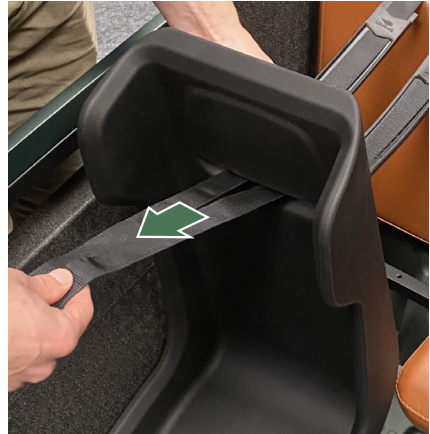
Figuur 4 – Schouderriemen door de rugleuning voeren.
